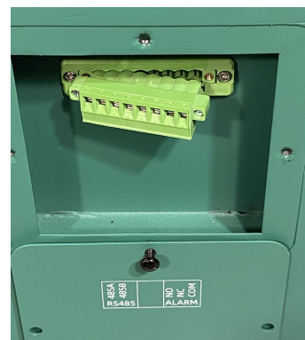
Клеммник RS-485 (485A / 485B) + аварийное реле
